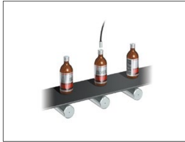
Detección de tapas de aluminio en botellas
