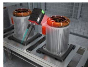
Verificación de marcado de códigos DataMatrix para motores EV
