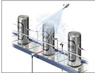
Control del paso de productos en un proceso de lavado. Sensor utilizado: PX-H71TZ
