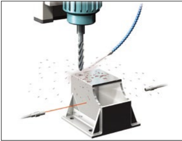
Control del paso del bloque del motor. Sensor utilizado: PX-H72G
