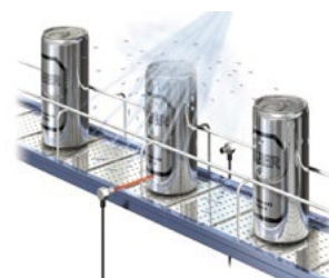
Control del paso de productos en un proceso de lavado. Sensor utilizado: PX-H71TZ
