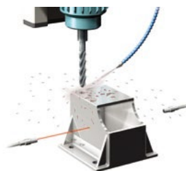
Control del paso del bloque del motor. Sensor utilizado: PX-H72G
