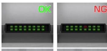
Control electrónico de presencia de componentes/diferencia de orientación
