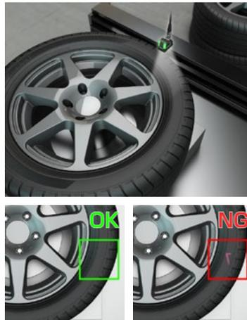
Comprobación de moldeo residual en máquina
