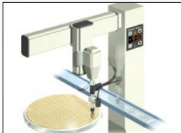
Comprobación de las condiciones de succión de los chips de circuito integrado
