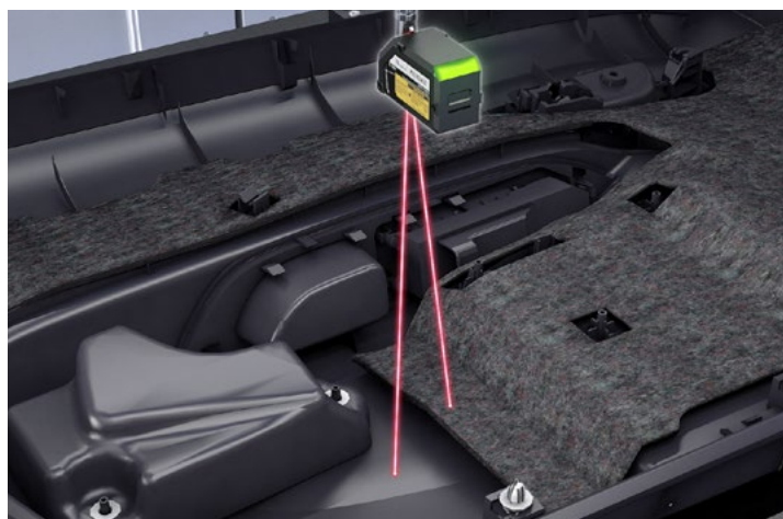
Comprobación de presencia de tela no tejida negra
