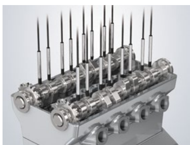
Inspección del descentramiento de árboles de levas
