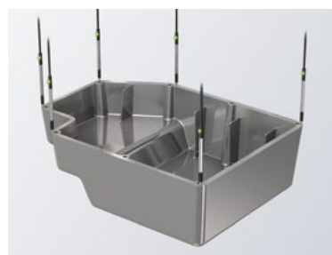
Inspección del grado de planicidad del carter
