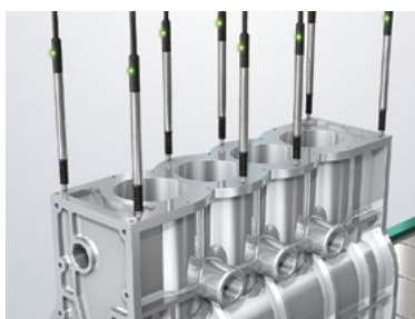
Inspección del grado de planicidad de un monoblock
