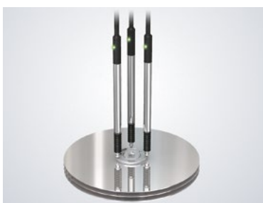
Inspección del paralelismo de la sección de sujeción de discos duros
