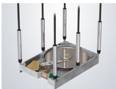
Inspección del conjunto de bastidor de los discos duros
