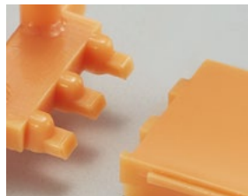
Corte de compuertas
