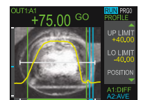
Medición de perfiles en pasta para soldadura de PWS
