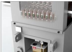
Inspeccione la presencia de obstrucciones en aplicación de aceite lubricante
