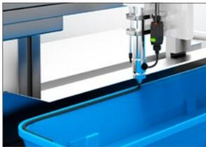
Inspeccione la presencia de obstrucciones durante la aplicación del sellador
