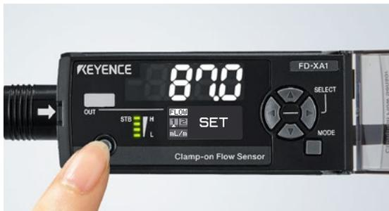
El sensor selecciona automáticamente el punto de ajuste adecuado mediante el muestreo de los valores de flujo mientras presiona el botón SET (Ajustar).
