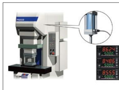
Control de presión en una prensa hidráulica
