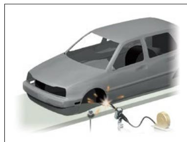
Detección de la presencia de piezas para la soldadura por puntos
