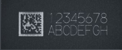
Marcado convencional (desviación del punto focal)
